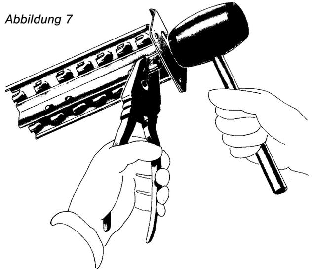
**Metallfuß** mit den beiden lamellenförmigen Halterungen auf die Pfosten setzen und mit einem Hammerschlag die Lamellen hinter den halb-kugelförmigen Noppen fixieren. (Abb.7)
